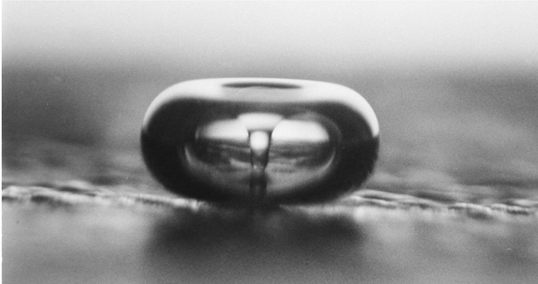
*Bolla di cavitazione vista al microscopio elettronico.*
